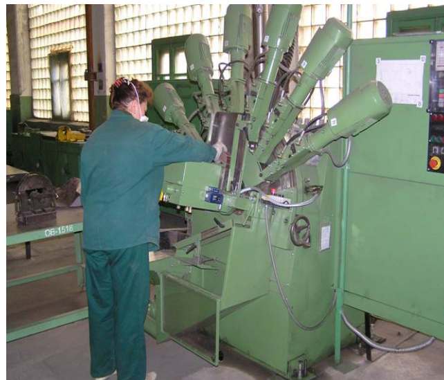
Mehrspindelbohrmaschine zum Bohren der Scheibenbremsbelaege
