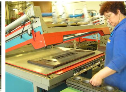
Beschichtung mit Silicondichtungsmittel
