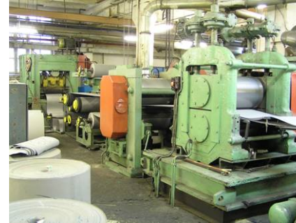
Herstellung vom Sandwich-Material auf der Grundlage des Spiesblechs
