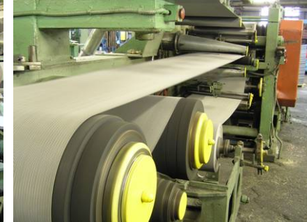
Herstellung vom Sandwich-Material auf der Grundlage des Spiesblechs
