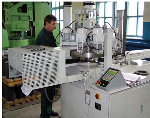
Automatische Bohrmaschine fuer das Bohren von ellipsenfoermig-aufgewickelten Reibbelaeagen
