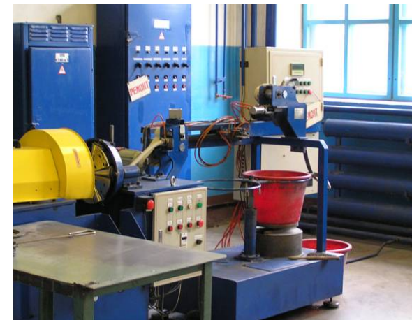
Automatische Maschine fuer das Aufwickeln von Rohteilen der ellipsenfoermig-aufgewickelten Reibbelaeage
